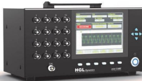
**Le CUBE** est un système d'acquisition de haute qualité de 8 ou 16 voies, conçu pour les applications nécessitant un système ultra portable sur site. Ses voies de sorties analogiques permettent de l'utiliser comme un data recorder et de rejouer les signaux mesurés en temps-réel ou a posteriori.
